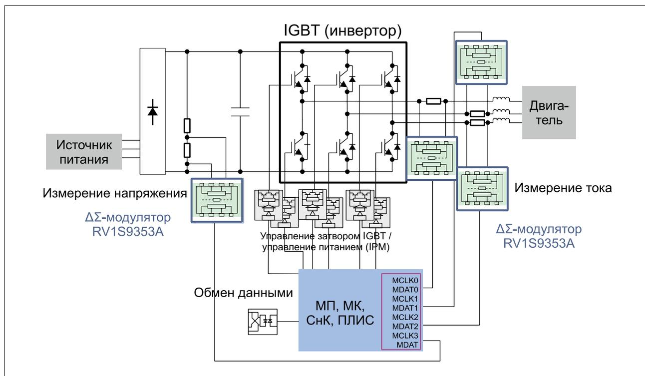
Рис. 1. Пример схемы инвертора
