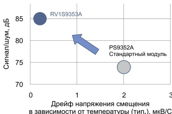
Рис. 5. Сравнение RV1S9353A со стандартным кристаллом PS9352A
