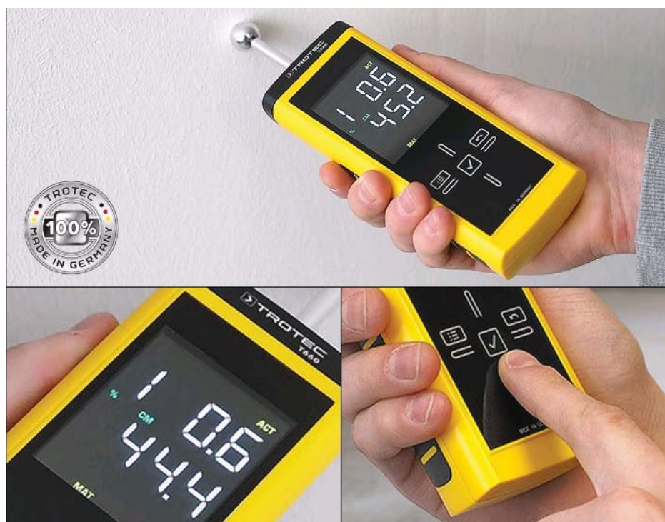
Рисунок 4. Диэлькометрический метод измерения влажности с прибором Trotec T660.
