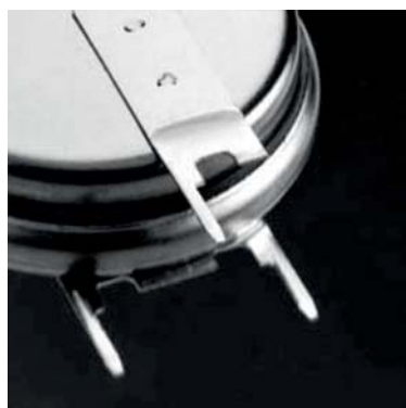
Рис. 4. Установка трех вертикальных контактов
