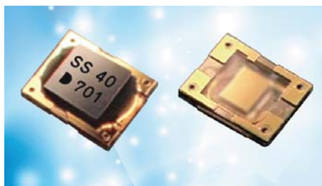
Рисунок 2. Кварцевый генератор 1,0×0,8×0,24 мм
