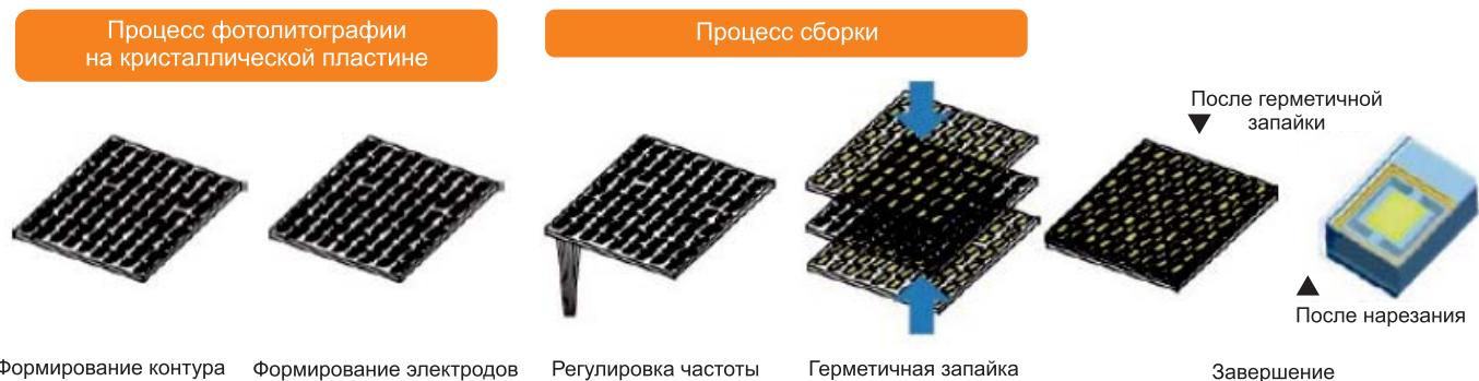
Рисунок 4. Процесс изготовления Arkh.3G
