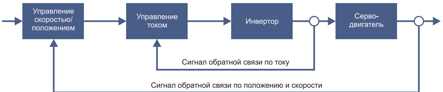
Рисунок 2. Сигнал обратной связи по положению, скорости и току
