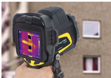
Рисунок 4. Функция наложения термографического изображения на реальный снимок у тепловизора Trotec HC600
