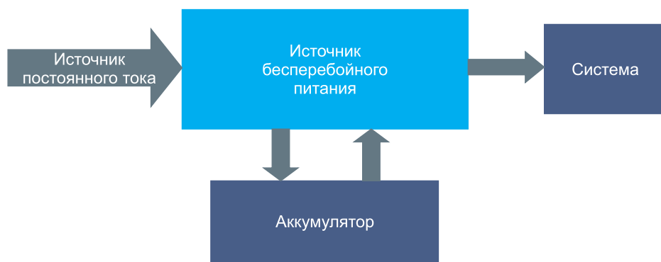
Рисунок 1. Типовая система батарейного резервирования
