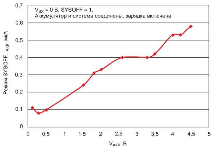
Рисунок 8. Ток утечки аккумулятора в режиме SYSOFF
