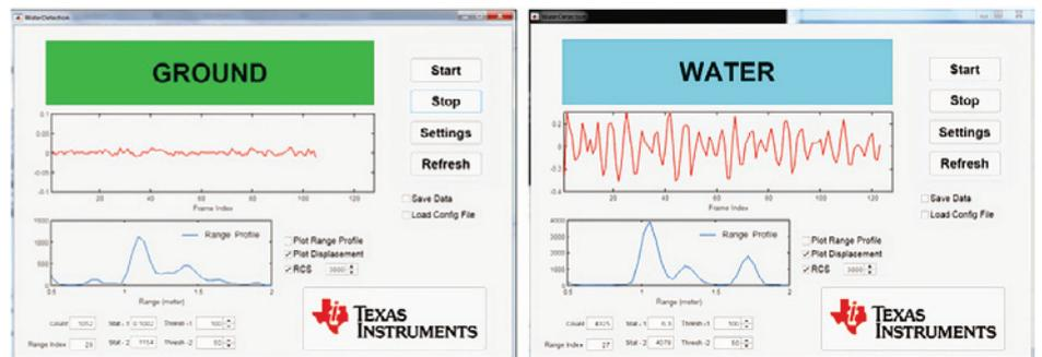
Рисунок 6. Использование миллиметровой технологии для определения поверхности суши или воды
