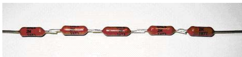
Рисунок 6. Последовательно включённые резисторы для снижения ёмкости
