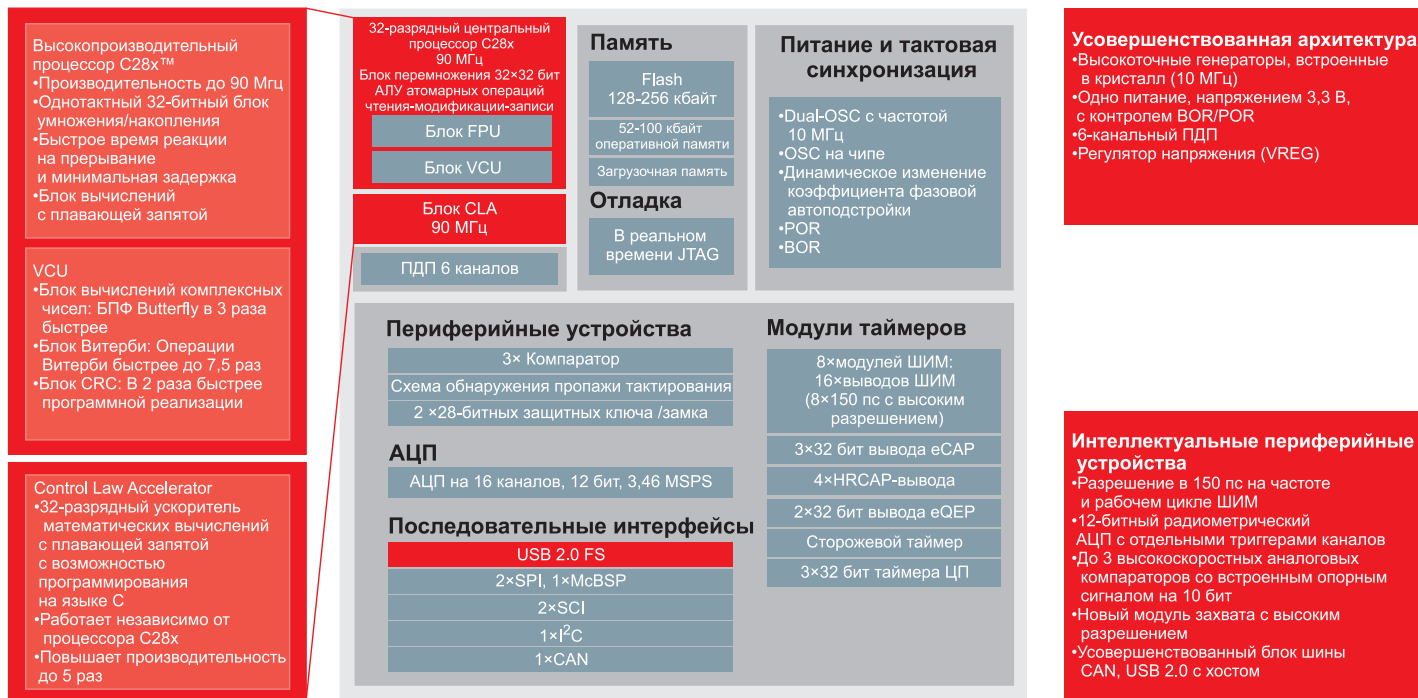
Рисунок. Микроконтроллеры Piccolo™ F2806x . Низкобюджетное решение для вычислений с плавающей запятой, совмещённое с управлением в реальном времени
