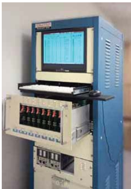
Рисунок 2. Coto Technology System 300. Система для испытаний долговечности реле
