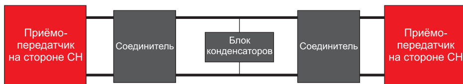
Рисунок 9. Схема испытательной установки для измерений в канале, соединяющем объекты в системе среднего напряжения
