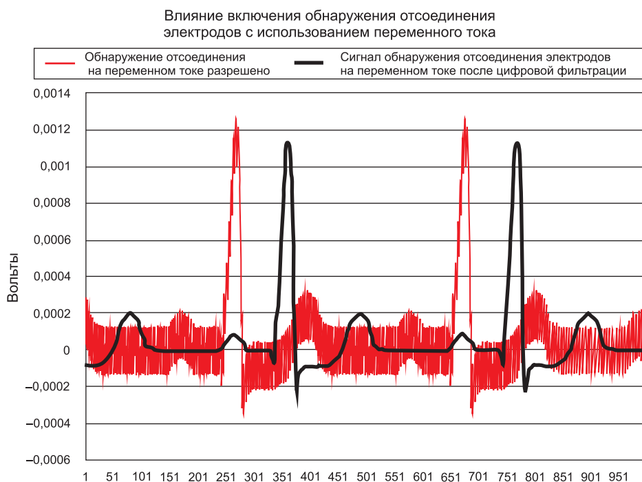
Рис. 5. Эффект обнаружения отсоединения электродов на переменном токе (Примечание. Графики сигналов сдвинуты по фазе, чтобы лучше были видны их особенности)
