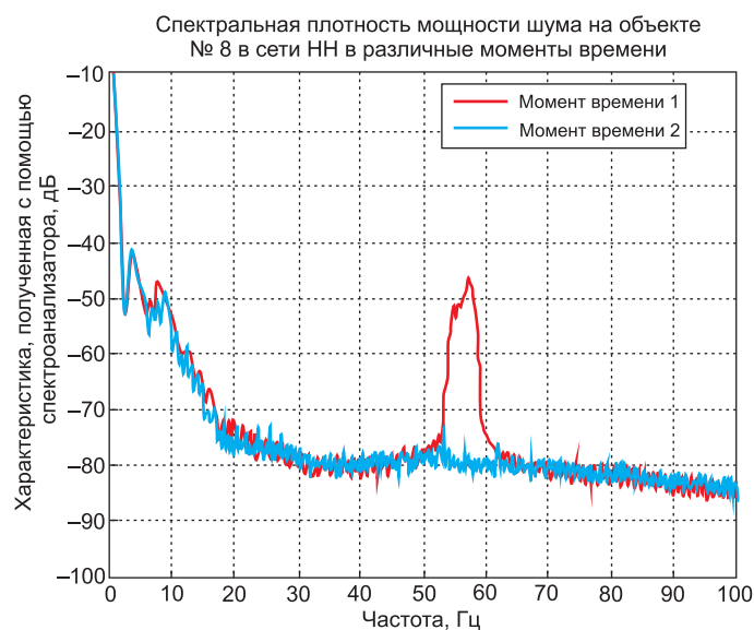
Рисунок 6. Спектры шума на объекте в сети НН в два разных момента времени
