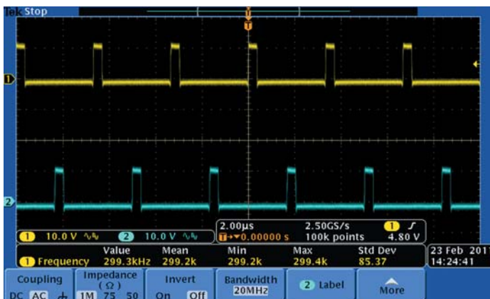
Рисунок 8. Напряжение в узле коммутации: V ВХ =12 В, V ВЫХ =1,2 В при 40 А
