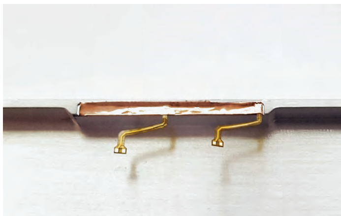
Рисунок 13. «Клетка Фарадея», экранированная медной фольгой
